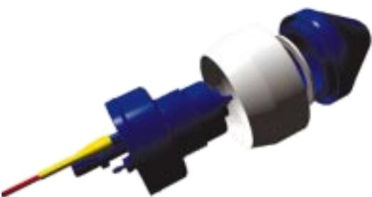
Boquilla MaxCharge™ fácil de desarmar y limpiar. La punta de cerámica el electrodo de acero inoxidable y los plásticos resistentes a químicos mantienen el funcionamiento de la boquilla por mucho tiempo. La mayoría de agricultores utilizan las boquillas con un promedio de 800 horas sin problemas.
